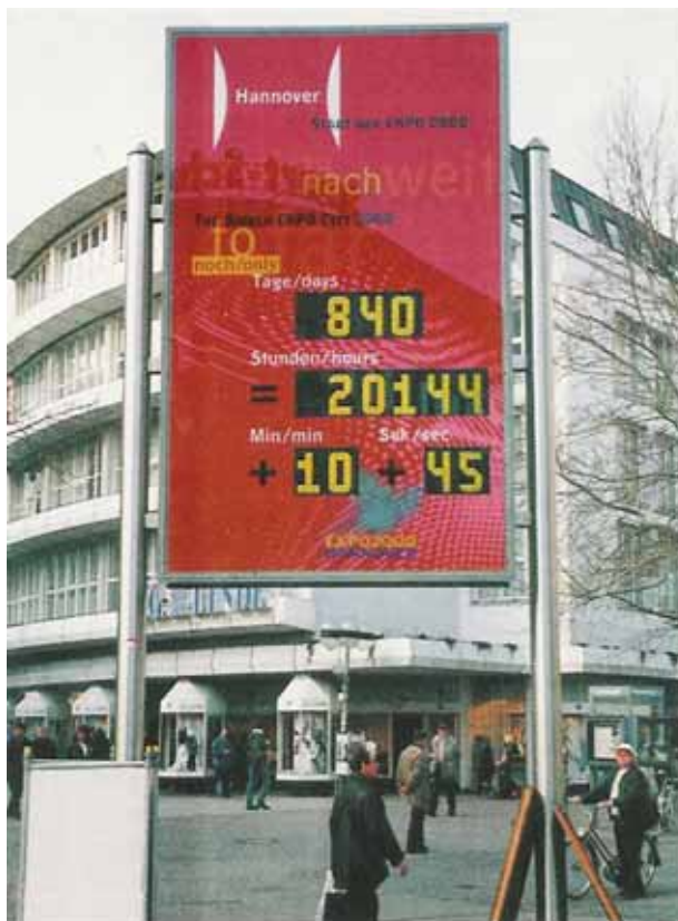
LCD-Countdownuhr doppelseitig, für EXPO 2000 in Hannover, Zifferhöhe 220 mm. Seit der EXPO zählt die Anzeige vorwärts.
