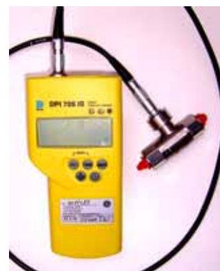
Ex-Gerät mit Diff.- Sensor
