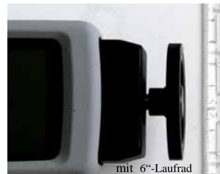
aufsteckbarer Adapter für mechan. Messungen ; ohne Adapter → für optische Messungen
