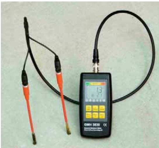
Betonmessung mit Bürstensonden GBSL91
