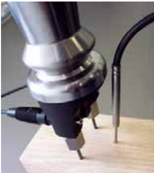
Hohlhammerelektrode GHE91 mit Temperaturfühler GTF38
