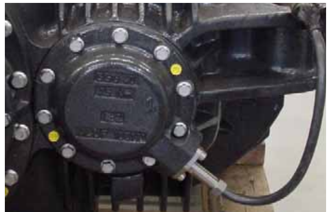
JAQUET Drehzahlensensor eingebaut in Bahngetriebe
